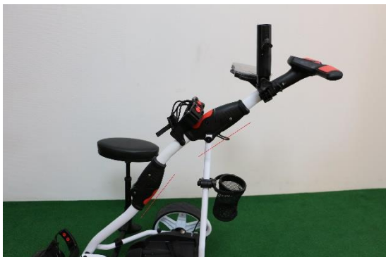
Afb 1 (scharnierpunten in rechte positie en geborgd door de kappen)
